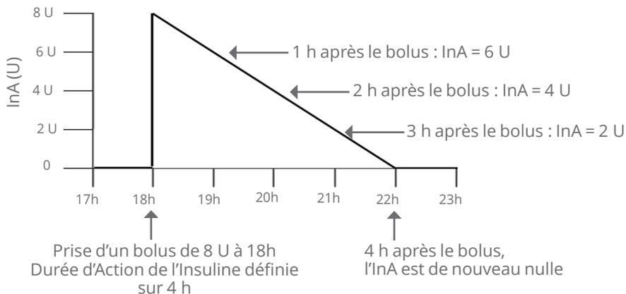
Dans le Système Omnipod 5, l'InA de correction peut également changer en fonction des calculs de la technologie SmartAdjust. Elle peut augmenter ou diminuer automatiquement.
